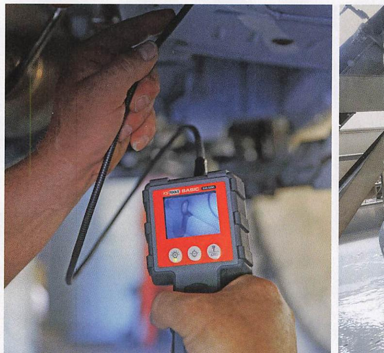
Die Fahndung mit Endoskopkamera an einem nagelneuen Ducato zeigt: Hohlräume werden ab Werk nicht mit Rostschutzwachs geschützt.
