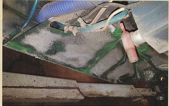
**2** Werden nur Anrostungen gefunden, werden diese phosphatiert, nach 24 Stunden erneut mit Trockeneis gestrahlt und dann zum Schutz mit einer polymeren Vorbeschichtung versehen.
