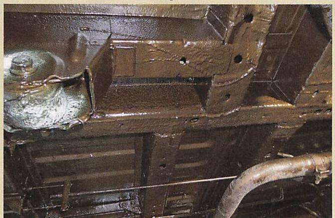
**6** Derartig gegen Korrosion präpariert, hält Fahrzeugblech fast für die Ewigkeit und der Rost hat nicht länger entscheidenden Einfluss auf die Lebensdauer des Mobils.
