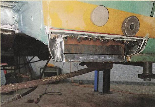
**3** Wenn die braune Pest schon stattliche Löcher ins Blech gefressen hat, kommt man um eine Instandsetzung der Karosserie, z. B. mit eingeschweißten Reparaturblechen, nicht mehr herum.
