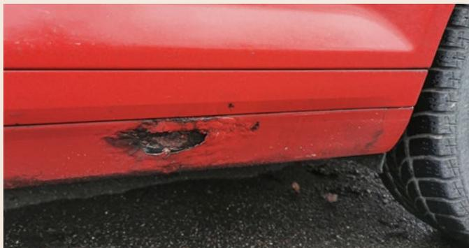
**Schweller** sind innen hohl. Laub, Dreck und Feuchtigkeit können sich hier mit der Zeit ansammeln. Bei ungenügendem Hohlraumschutz entsteht Rost. Aber der Lack kann auch von außen – ähnlich wie bei der Motorhaube – von kleinen Steinchen oder Salzwasser beschädigt werden und abplatzen
