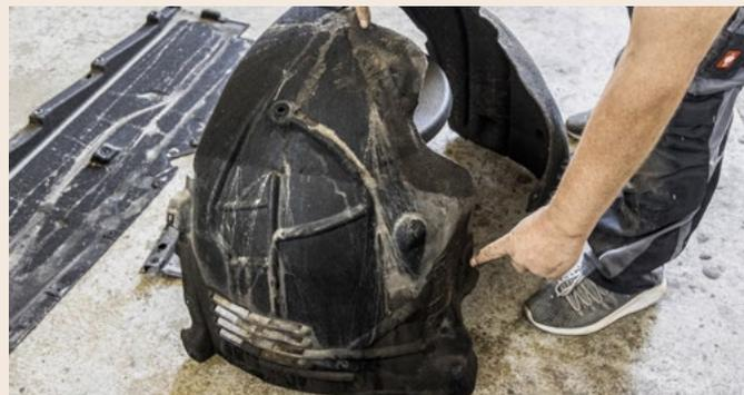
**Innenkotflügel** Wasser und Dreck laufen häufig über die Radläufe hinter die Innenkotflügel, gelangen dann in den Hauptschweller und bleiben in der Unterbodengruppe stehen. Dieser Vorgang ist auch schon bei diesem sechs Monate alten Audi A6 zu erkennen
